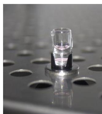
Рисунок: Sv2 датчик системы контроля уровня pH SAFE Sens® в инкубаторах большого объема.
