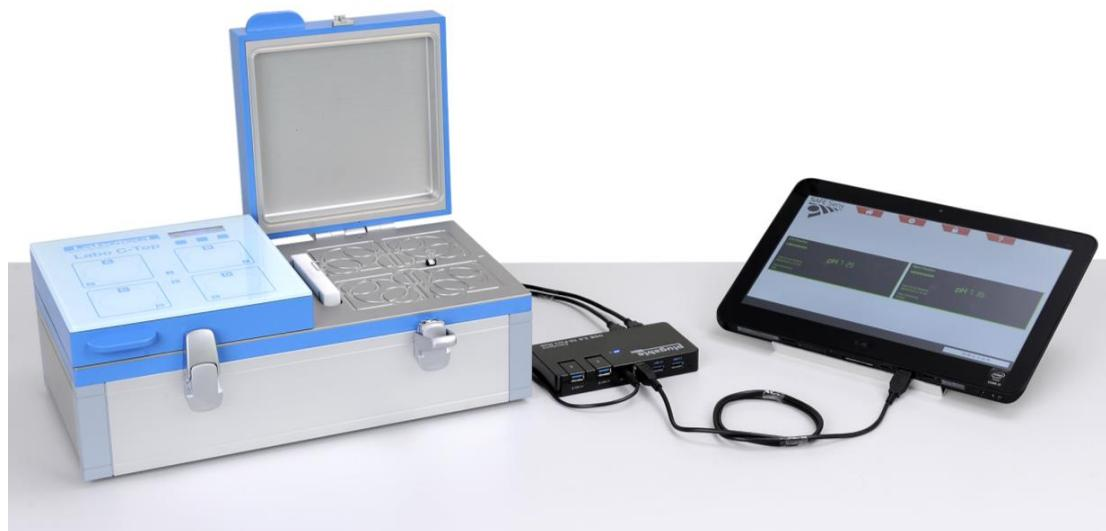
**Настольный инкубатор с интегрированной технологией постоянного и неинвазивного контроля уровня pH SAFE Sens®.**
