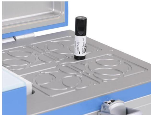
Датчик для калибровки qc2 SAFE Sens® на датчике sv2 TrackPod™ настольного инкубатора Labo C-Top.
